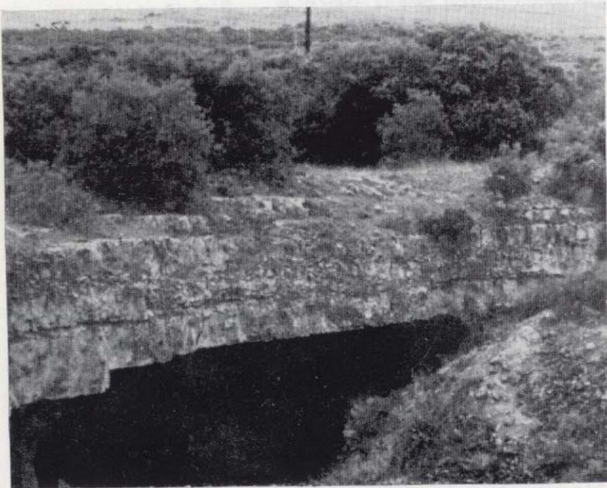
Figura 4.—Aspecto exterior de la cantera en activo. Se observa la inclinación de los estratos existentes a techo del banco en explotación.
